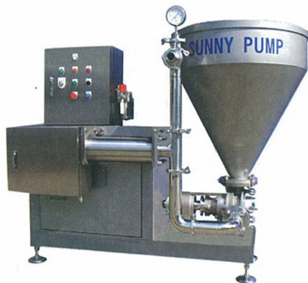
Подающий насос Sunny Pump System с интегрированным эквалайзером EQ-6V
