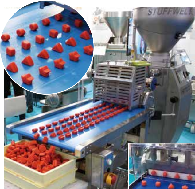
丸型、四角型、三角型、星型等、 いろいろな形状の吐出口を設計することができます。
