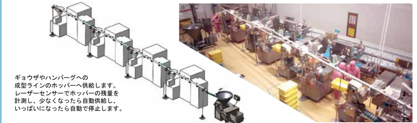
ギョウザやハンバーグへの成型ラインのホッパーへ供給します。レーザーセンサーでホッパーの残量を計測し、少なくなったら自動供給し、いっぱいになったら自動で停止します。
