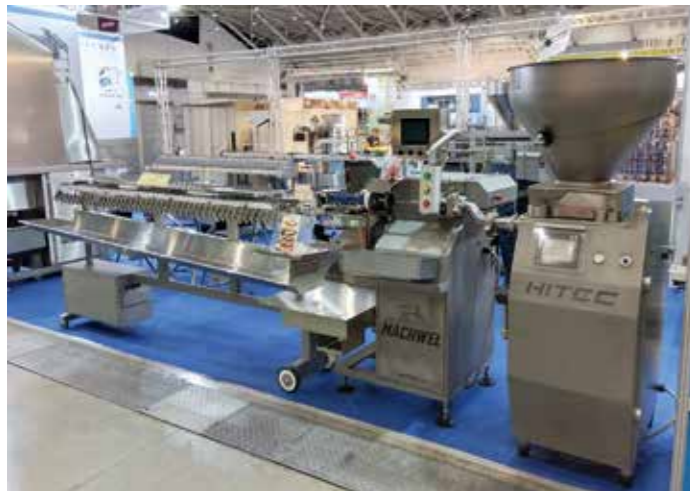
スタッフウェル 60 + 天然腸ソーセージ高速定寸量充填機 マックウェル。 幅広い食品加工機械との連携が可能です。
